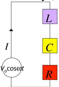
$$V_0 e^{i\omega t} - L\ddot{q} - \frac{q}{C} - R\dot{q} = 0$$
