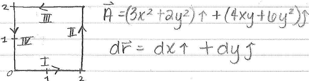
$$\oint_C \vec{A} \cdot d\vec{r} = \int_I \vec{A} \cdot d\vec{r} + \int_{II} \vec{A} \cdot d\vec{r} + \int_{III} \vec{A} \cdot d\vec{r} + \int_{IV} \vec{A} \cdot d\vec{r}$$
